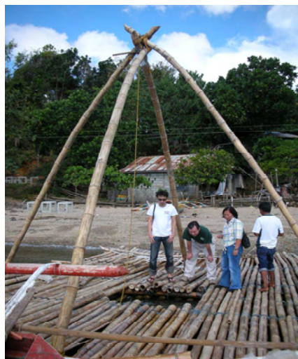
人工漁礁運搬用の筏（プロジェクト・チームが作図・発注）。真ん中の穴から漁礁を海底に沈める。
