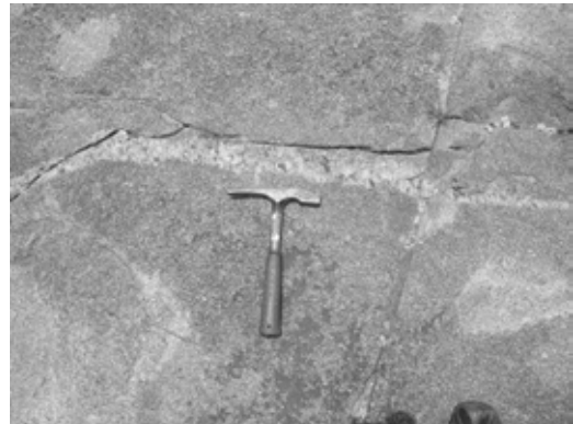
基盤岩地域に分布する岩石（花崗岩類およびメグマタイト脈） Kondokhou 村北方 基盤岩地域に分布する花崗岩類の露頭の例。粗粒な花崗岩の深層風化域やペグマタイト脈・石英脈の貫入部で地下水ポテンシャルが高い。
