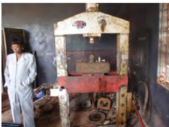
WATSAN プロジェクト事務所敷地内のワークショップ内の状況。修理工が常駐し、機器の整備・修理を行っている。写真はプレス機で老朽化が進んでいるが、使用頻度は高い。井戸掘削機材はすべてこのワークショップで修理されている。
