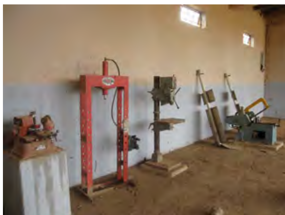
ワークショップ家屋内の旋盤機、プレス機、切断機、グラインダー等の修理機器の状況。修理機器の整備状況は良好であり、修理頻度が高いことが伺われる。
