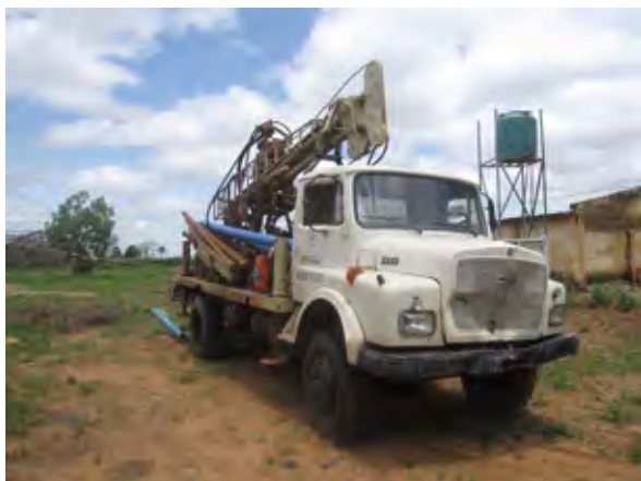
UNICEF から 1995 年に給与された 2 台の井戸掘削リグのうち一台の状況。このリグは老朽化し修理不能であるが、もう一台は稼動中である。
