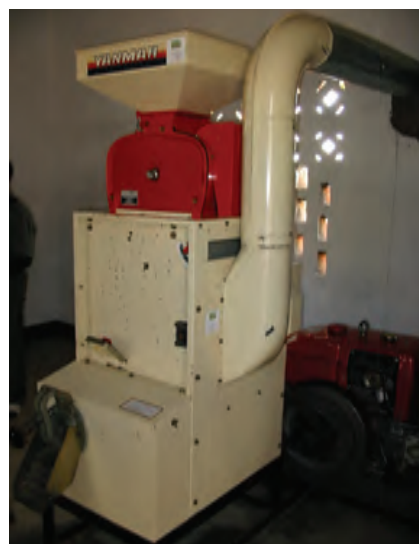
Morire の稲作農民組合の精米施設 (精米機はブラジルの Yammer 社製) (ザンベジア州 Morrumbala 県)
