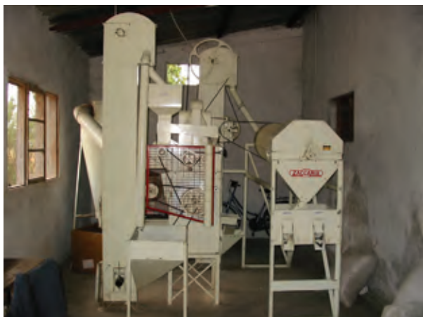
Associação Agrícola da Paz の精米施設 (精米機はブラジルの Zaccaria 社製) (ザンベジア州 Mopeia 県)
