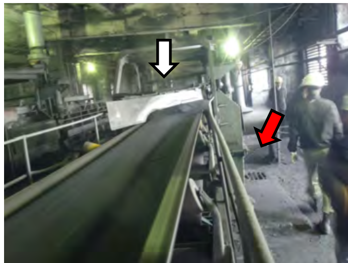
Hình 2.3-10 Khi rót than vào boong ke
