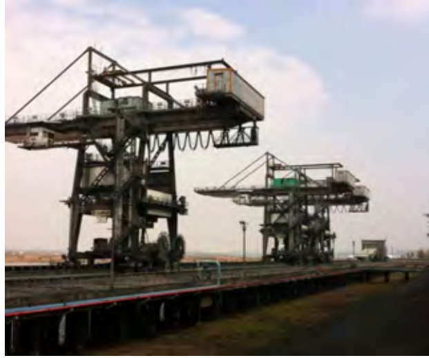
Hình 2.3-5 Cầu trục đỡ than kiểu giá treo ở nhà máy Phả Lại II
