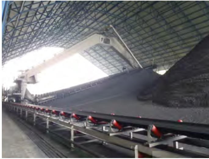
Hình 3.3-9 Băng tải của kho trữ than
