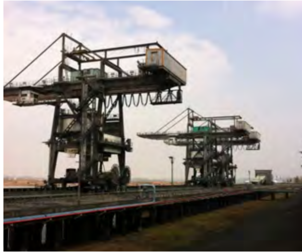
図 2.3-5 Pha Lai II のクラブトロリ式橋型クレーンアンローダ
