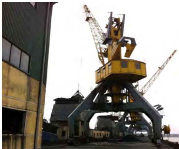
図 2.3-4 Pha Lai I のロープバランス式引込クレーンアンローダ
