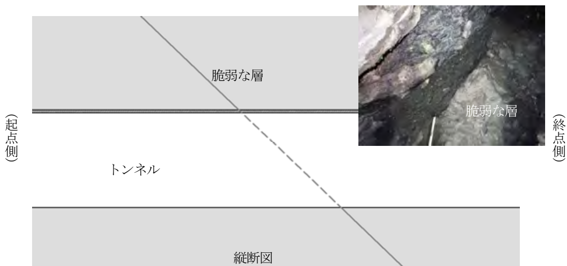
図-4 トンネル No. 2 変状箇所付近の地質構造
