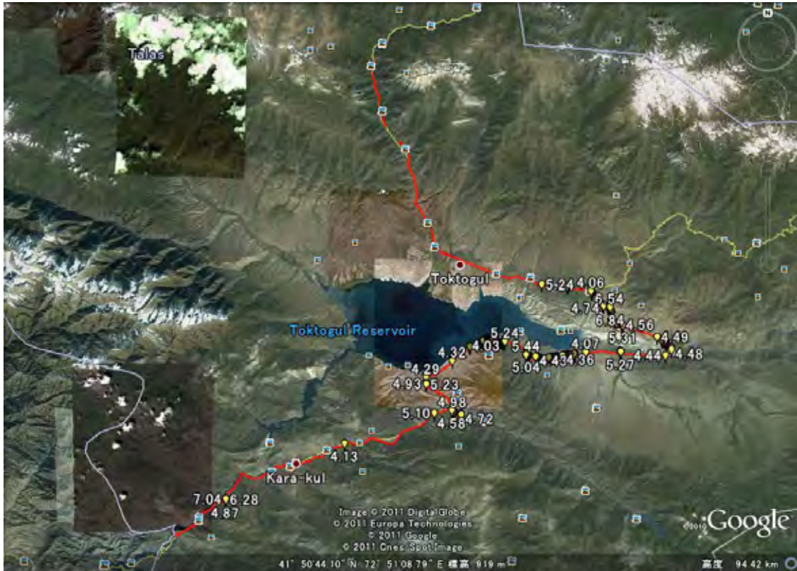
図-8 調査対象区間全線において IRI が 4 以上 8 未満であった区間
