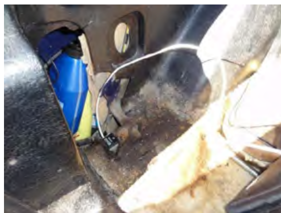
加速度センサー取付け状況
