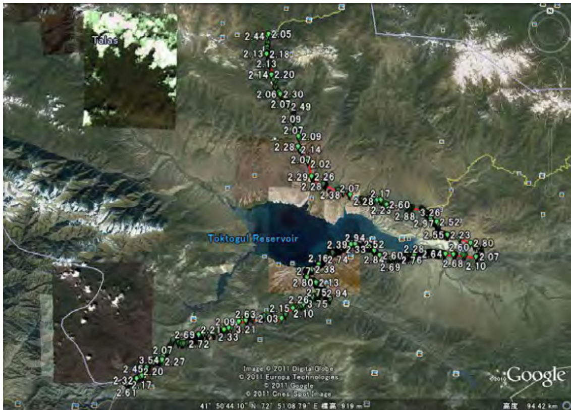
図-7 調査対象区間全線において IRI が 2 以上 4 未満であった区間
