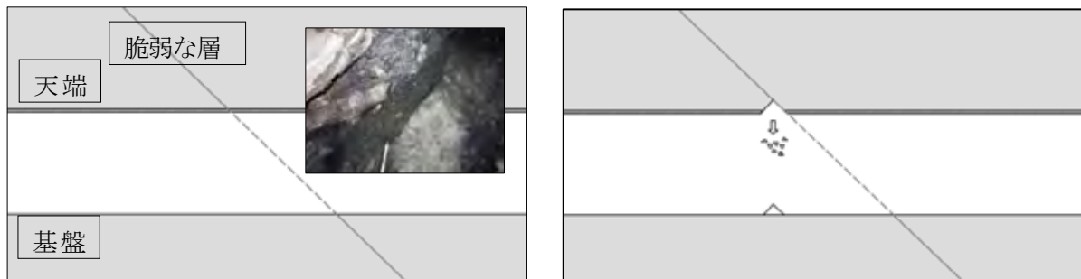
図-24 トンネル No. 2 の変状発生概要図
