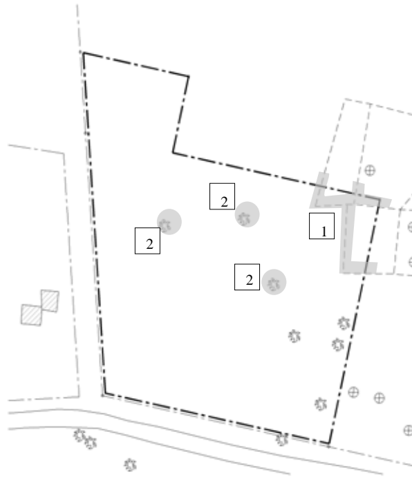
Schéma 2-24 Ouvrages à démolir et arbres à transplanter pour la construction du CS de Salémata
