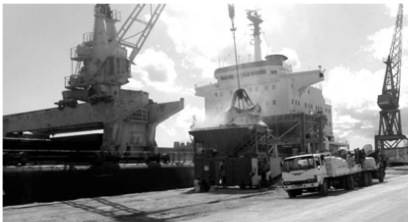
Figura 2.5-22 Descarregamento e embalagem dos fertilizantes no cais
