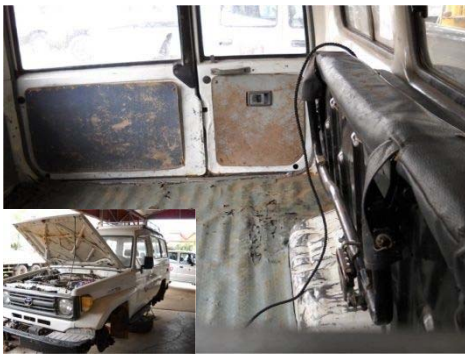
整備中のステーションワゴン。内部は激しく劣化している。
