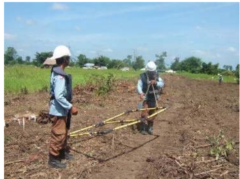
高深度用埋設物探知機は地雷探知・除去後の最終確認及び、UXOの探知にも不可欠であり、必要性が高い
