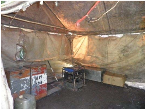
発電機は探知機のバッテリーの充電等に、不可欠であるが、「カ」国内で市販されている発電機は耐久性や品質に問題が多い
