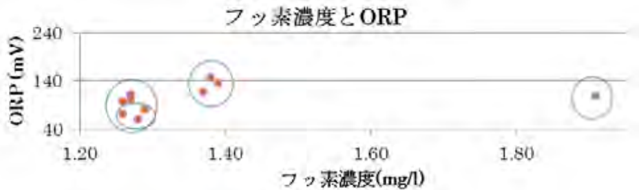
図 3.4.10 カコラ村 BH1 における掘削中の揚水のフッ素濃度と ORP の散布図
