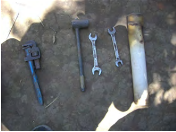
⑬エアリメカニクが常時携行している工具類 左から、パイプレンチ、ボックススパナ、スパナ、ソケット用ジグ (撮影日:2010年11月5日)
