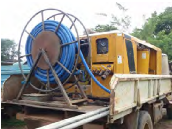
WATSAN プロジェクト所有のコンプレッサー。1992 年 UNICEF から 2 台供与された。写真のコンプレッサーは現在でも使用可能だが、老朽化による能力低下のため井戸掘削作業には使用されず、井戸のリハビリテーション作業にのみ利用されている。
