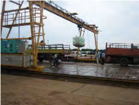
(機械化荷役) 棧橋での小型クレーンを使った荷役。機械化荷役は限定的である。
