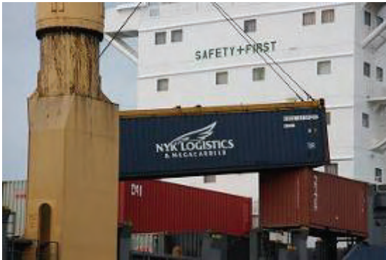
写真1 シップギアによる荷役作業
