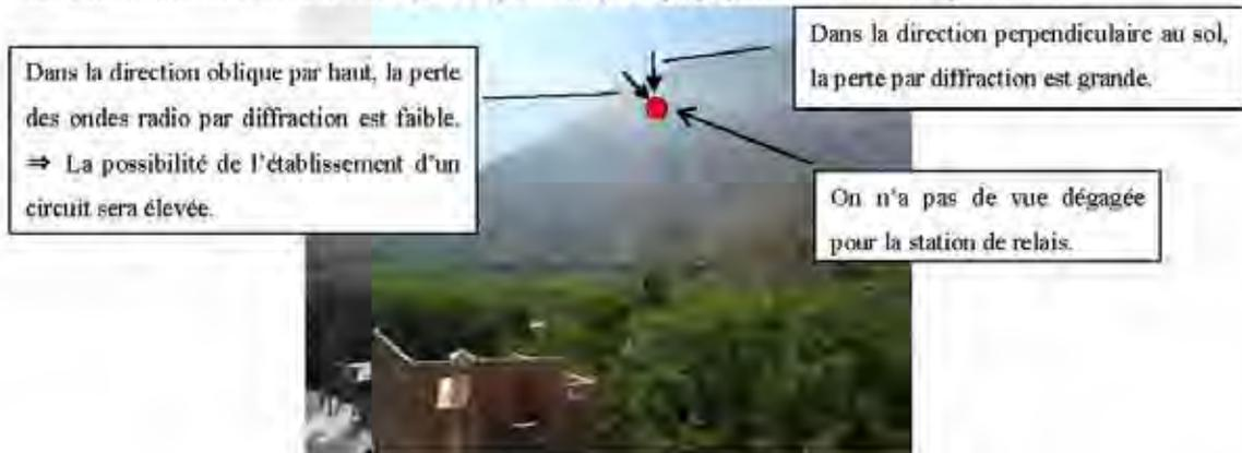
Figure 1-2 Lorsqu'on n'a pas de vue dégagée pour la station de relais.
