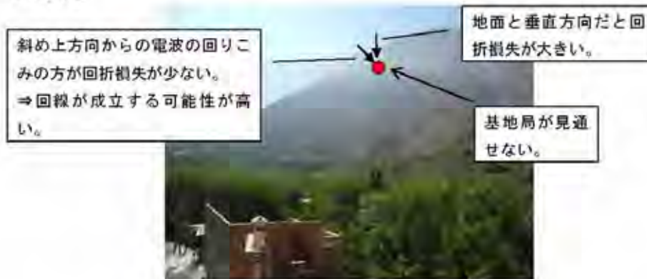
図 1-2 基地局が見通し外の時の考え方。
