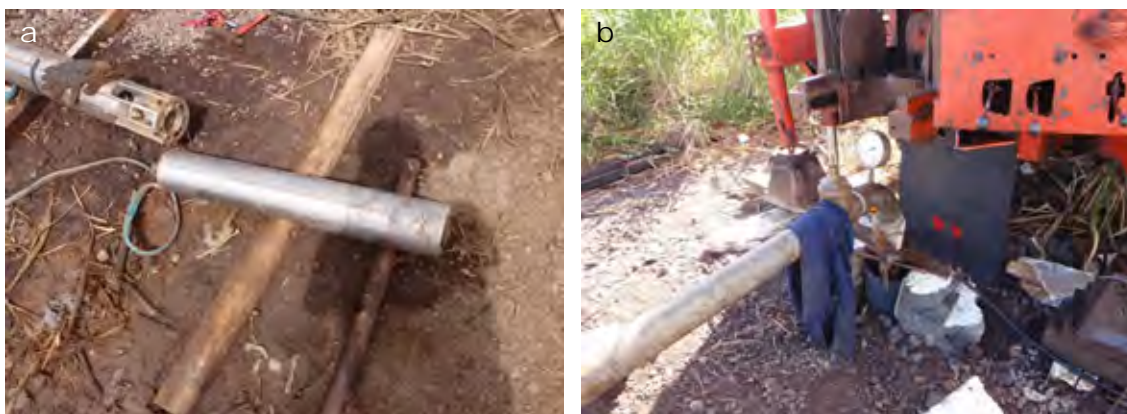
図 4.3-4 (a) 揚水試験に用いるポンプ; (b) 揚水量の計測
