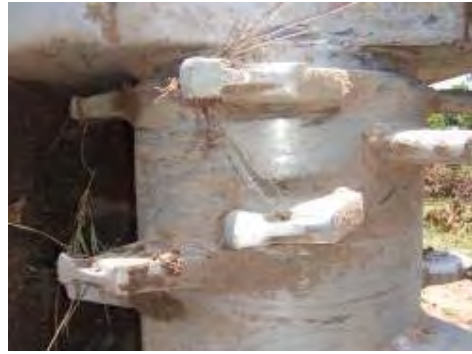
灌木除去機は土砂との接触も多く磨耗が早く修理頻度も高くなっている
