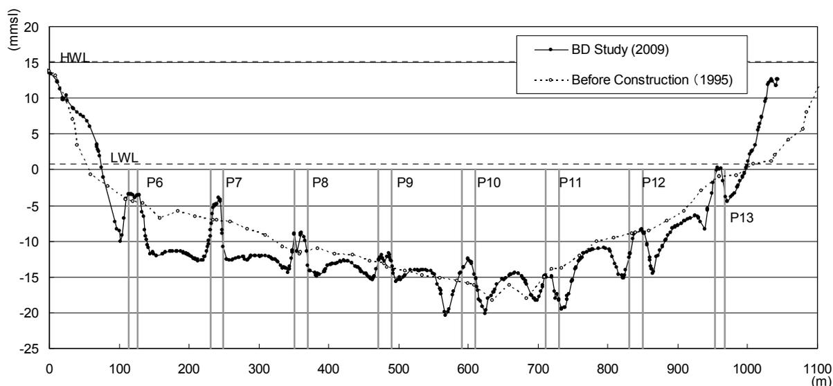
図 2.2-17 きずな橋の洗掘状況(河川横断)
