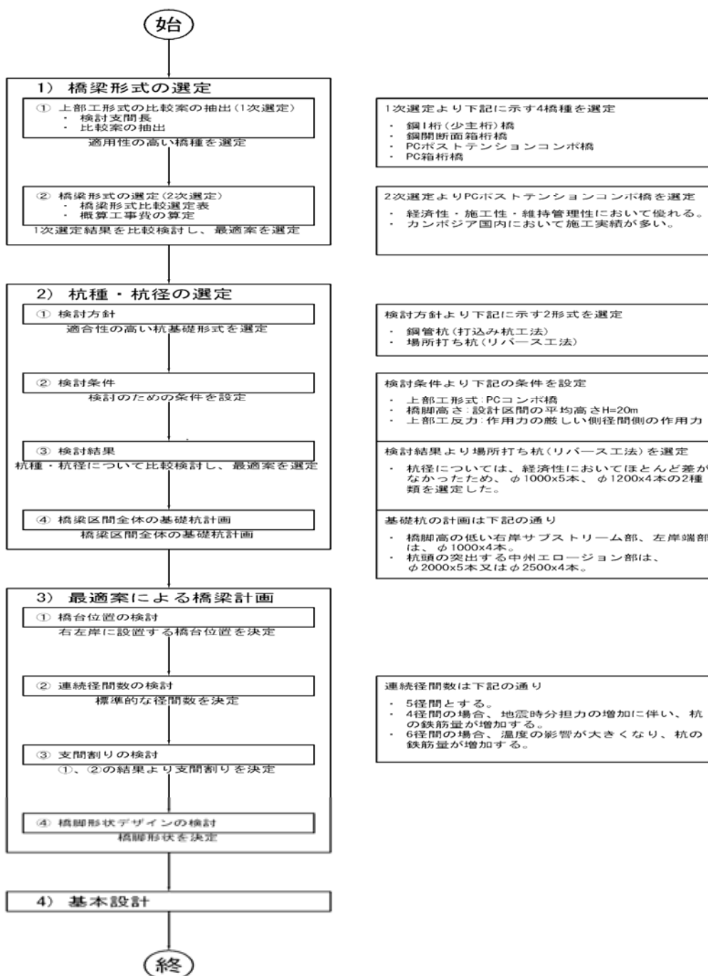
図 4.2-18 取付け橋検討作業フローチャート
