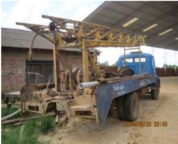
ベニ県民間井戸業者所有機材(Todo Agua Srl社) ロータリー式トラック搭載型160m級(1985年式)
