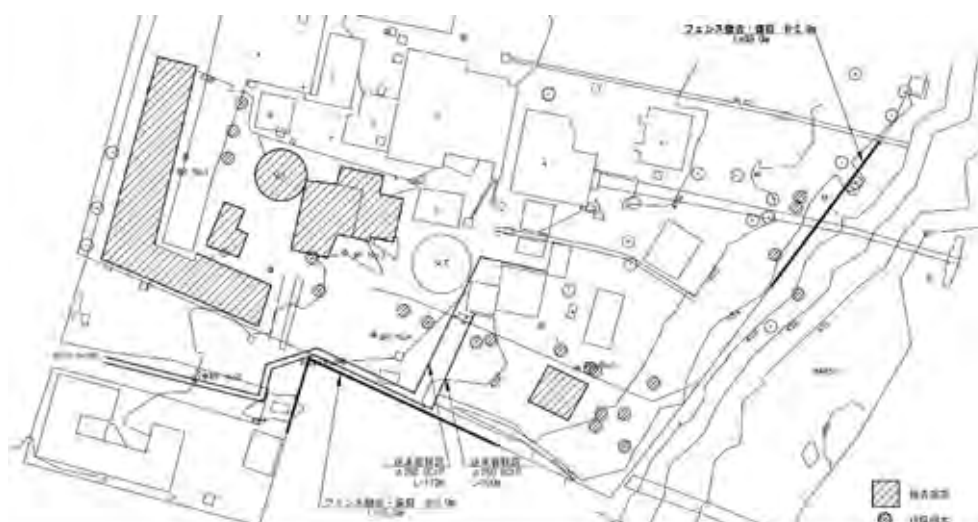
図 3-9 浄水場建設予定地の撤去対象施設
