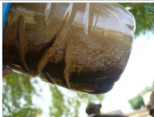
Aoure エアリフトによる排出物
