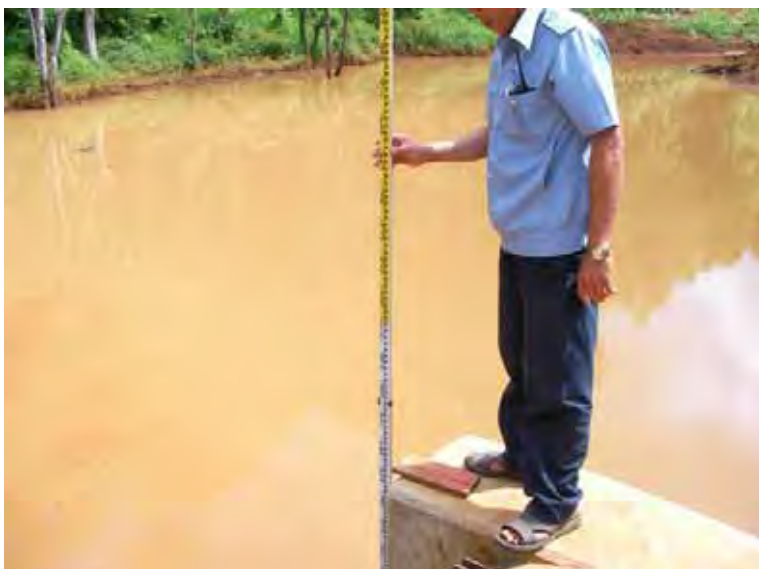
取水口前面での堆泥厚測定
