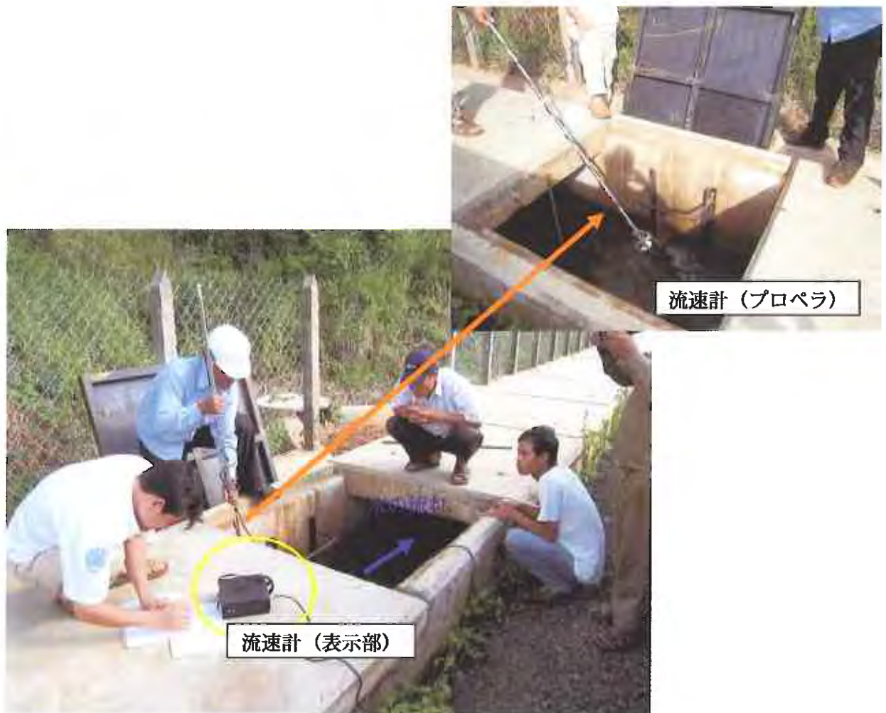
流量測定状況
