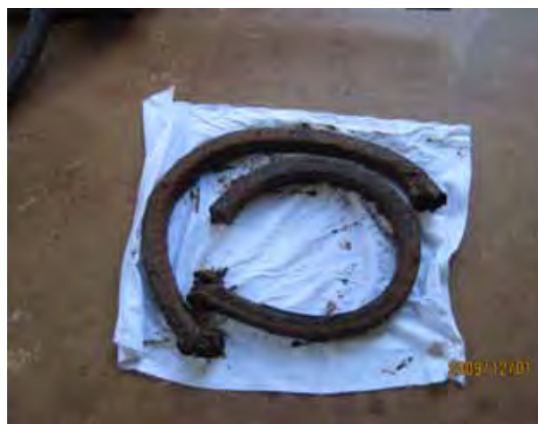
取替えたパッキンの汚れ具合 (運転 1 年後)
