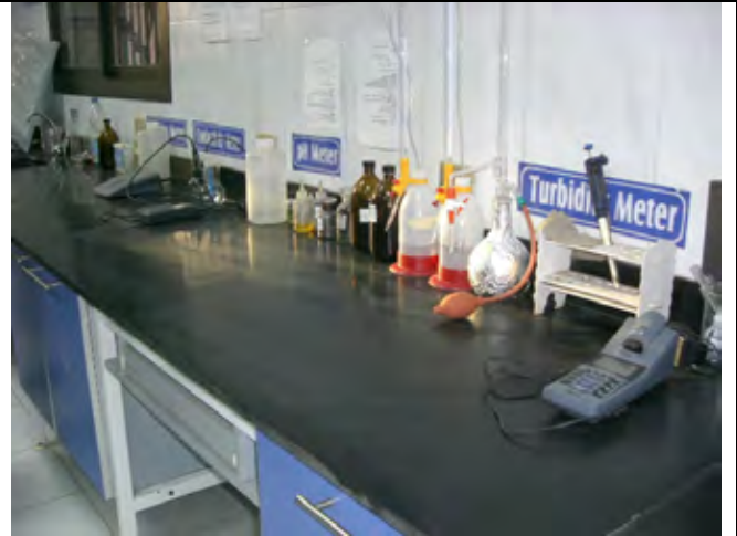
pH、濁度等の計器
