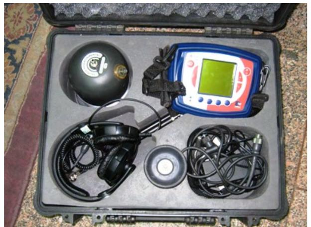
ガルビーヤ県 漏水探査機器
