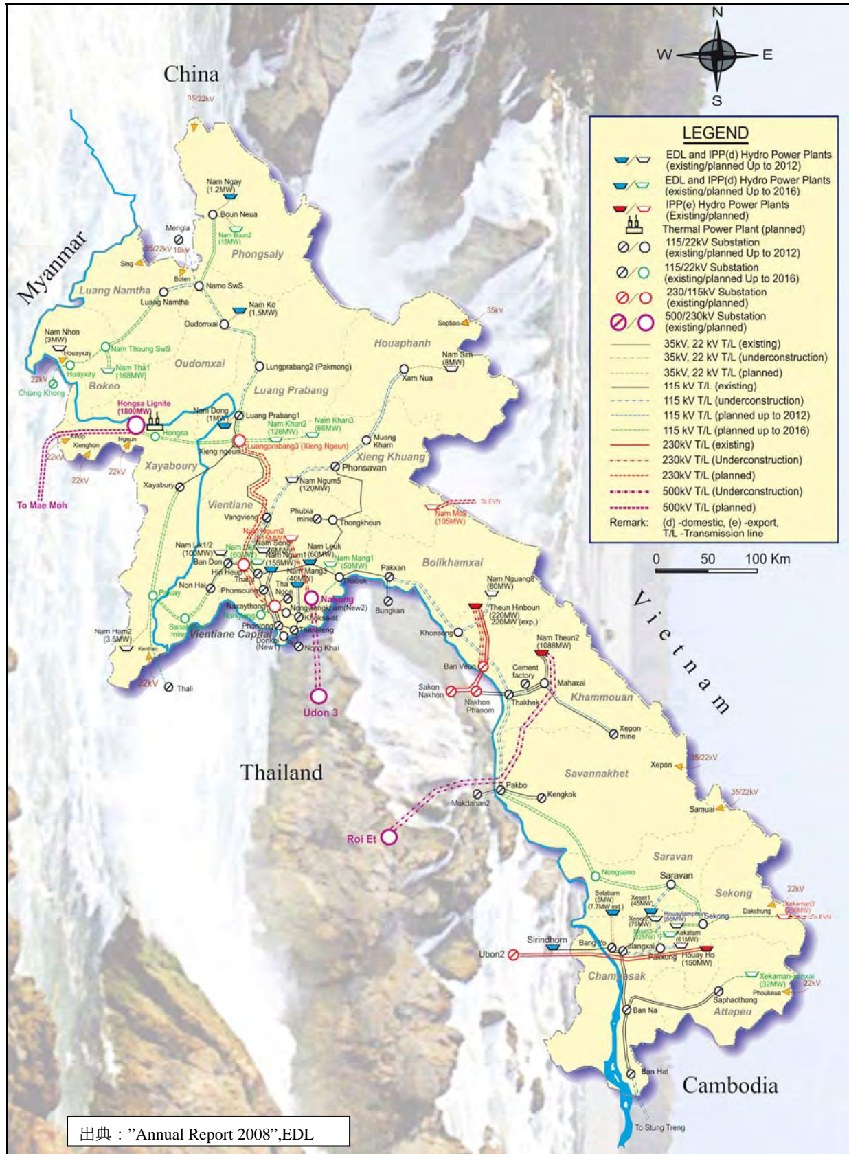
図 1-1.2 ラオス国電力系統図(2008年)
