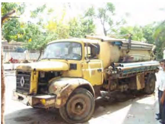
DSDで所有されている排水システム清掃機材（汚泥吸引車）。この機材は供用開始から20年以上が経過して老朽化が著しいが、現在も使用されている。
