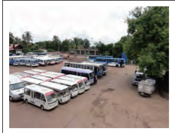
バス公社: 中国製電気バスが故障のために停車中。新バッテリーの輸入待ち。
