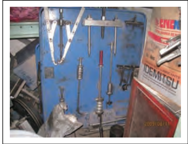
整備機材 手工具類:比較的良好に整理整頓されている。ただし、工具の種類が少ない。適切な工具がない。
