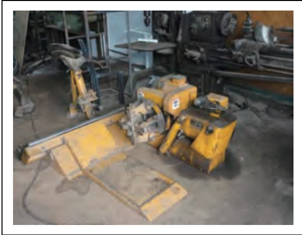
整備機材 タイヤチェンジャー:日本の無償(1988年)により供与。老朽化しているが現在も稼働中。
