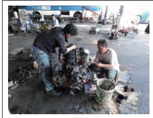
バス修理状況: エンジンのオーバーホール。修理台がなく床の上でじかに修理しているため、ピストン内が完全に防塵できない。
