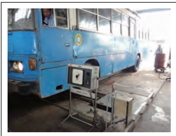
整備機材 ブレーキテスタ: 日本の無償(1988年)により供与。十分に利用している。
