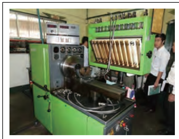
整備機材 燃料噴射ポンプテスタ: 日本の無償(1988年)により供与。十分に利用している。
