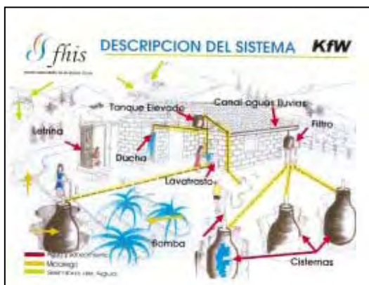
Captación Agua de Lluvia
