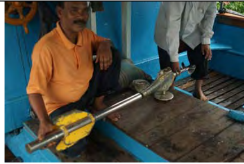
(2) ボイラブバザールの流量計
