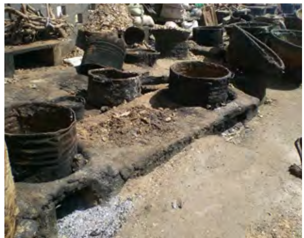
ゲンダール加工場の改良釜戸 火口が砂で埋まりつつある
