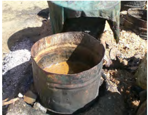
鉄製ボイル釜（セネガル製/ドラム缶を改造）
