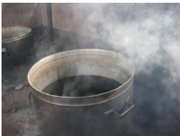
写真9. パーボイル加工（籾摺り精米加工の前に籾を温水に浸し、籾を水蒸気で蒸す加工）の様子。精米時の碎米発生率を下げるために行われる：北東州ボルガタンガ市
