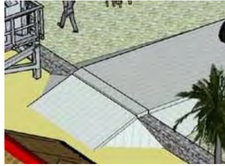
パラペットへの傾斜路の設置
