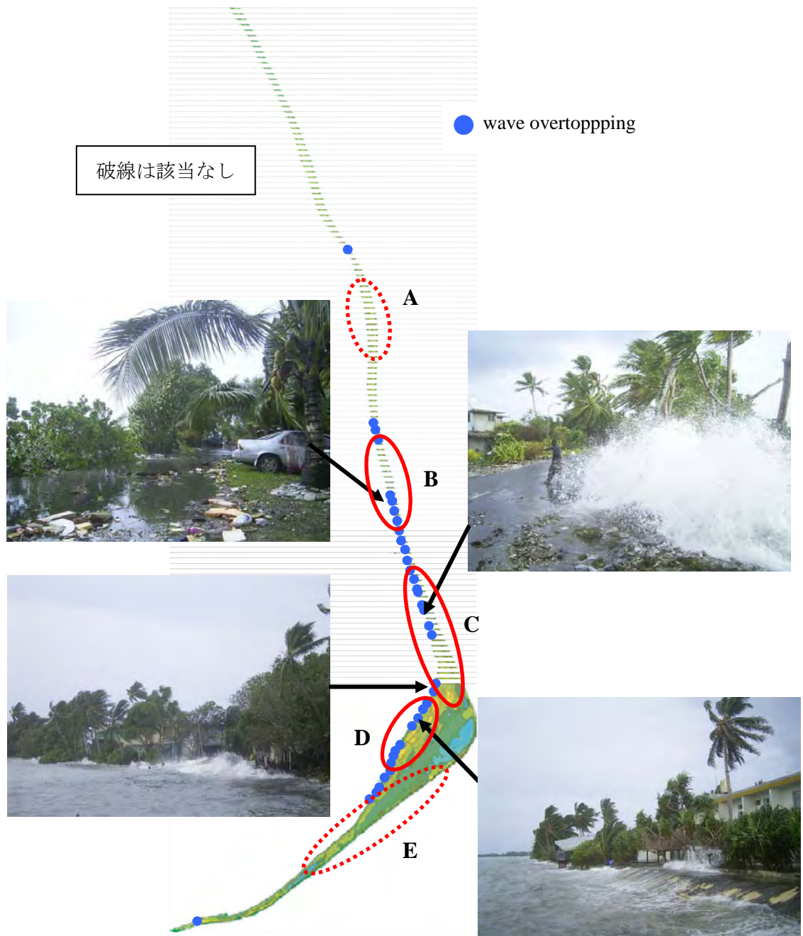
図 5.19 越波状況実態調査による被害状況分布
