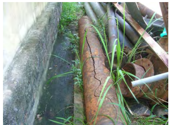
写真-5 シハヌークビル 大規模漏水によって交換され、水道局内に廃棄された普通铸铁管。管に亀裂が入っている。
