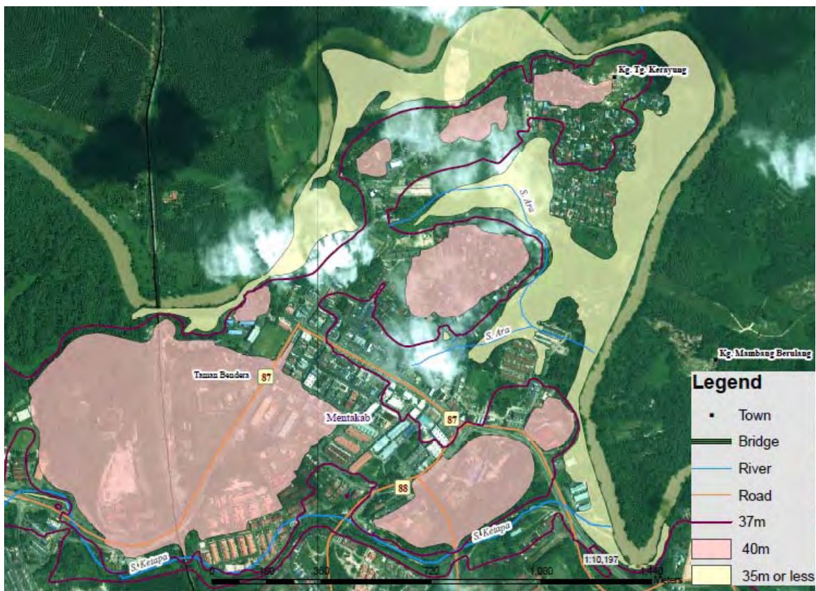
図 8.2.10 1971 年洪水(40m)と 1988 年洪水(37m)の最高水位相当のコンター図と低地標高(35m)レベル(Mentakab)
