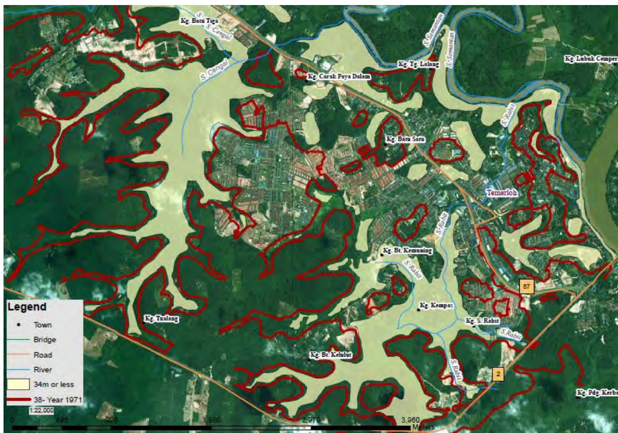
図 8.2.9 1971年洪水(38m)と1988年洪水(34m)の最高水位相当のコンター図 (Temerloh)
