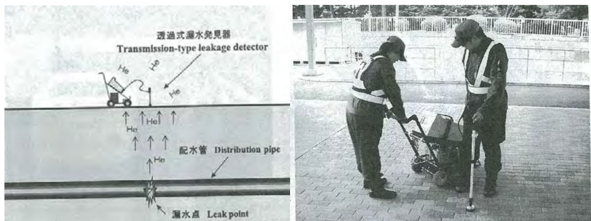
図-5 透過式漏水発見装置
