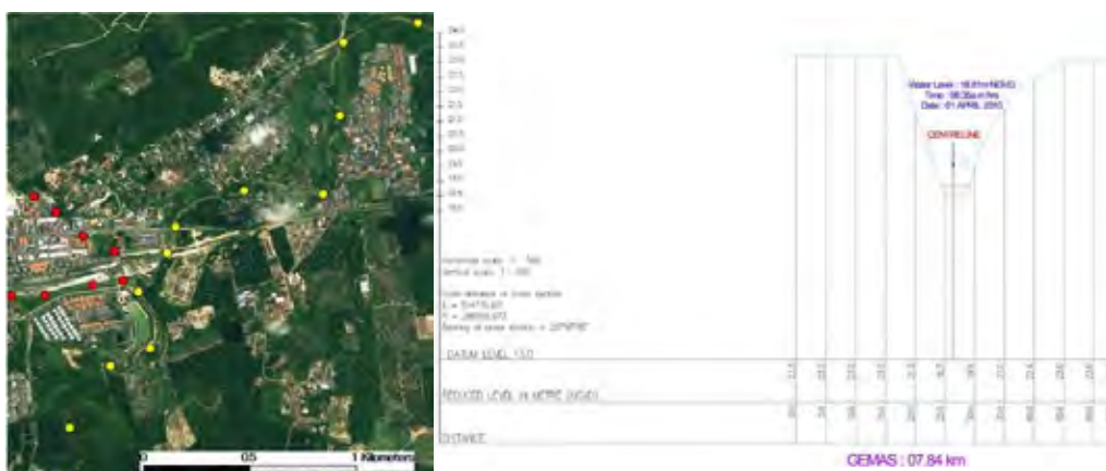
図 7.3.4 横断面位置 (左図、Gemas 川：黄色、支流と排水溝：赤) と測量成果のサンプル (右図)
