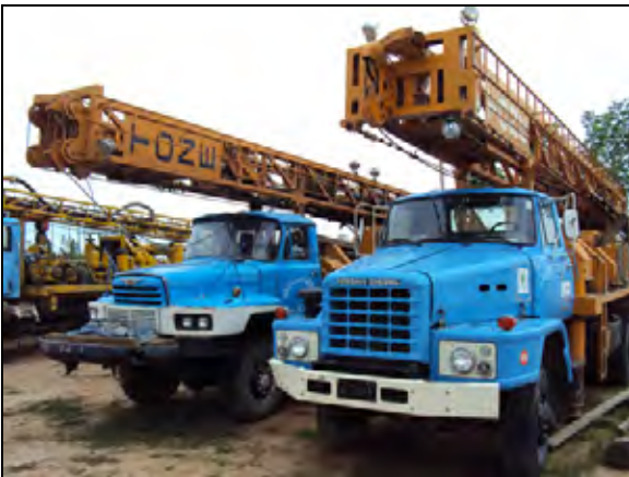
DDA 所有機材 1 井戸掘削機
