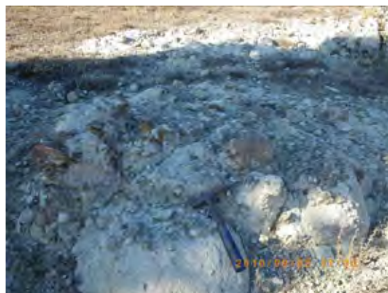
写真 5.31 調整池内の最上流部に分布する Gemiciköy 層(Temg)の凝灰角礫岩 (Temg(b))
