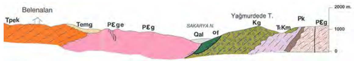
図 5.16 Adapazarı 地質図幅に示されている調査地の南北方向の模式地質縦断面図
