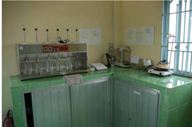
水質試験室 (ジャーテスター、pH メーター、電子天秤等)
