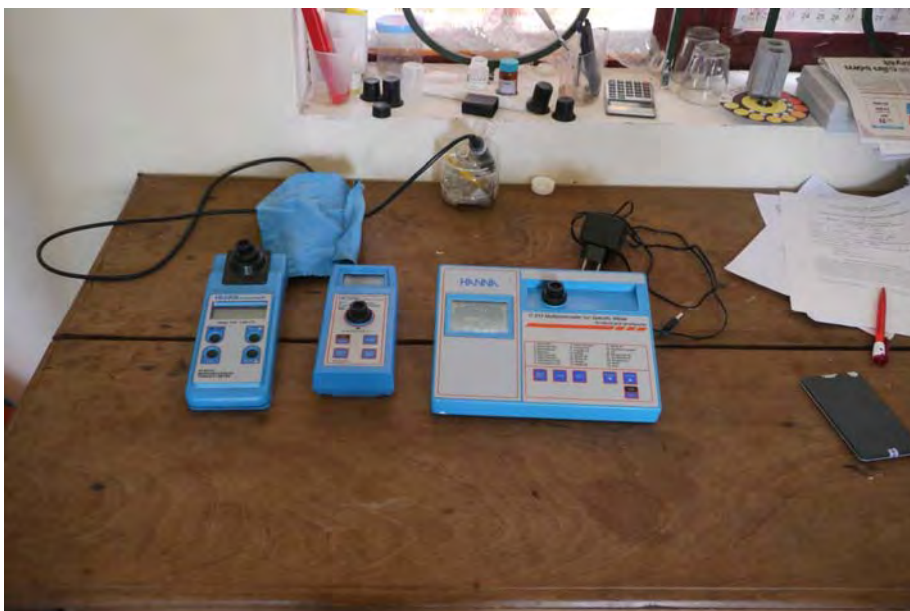
水質分析機器 (右側のものがイオン電極法による計測器)
