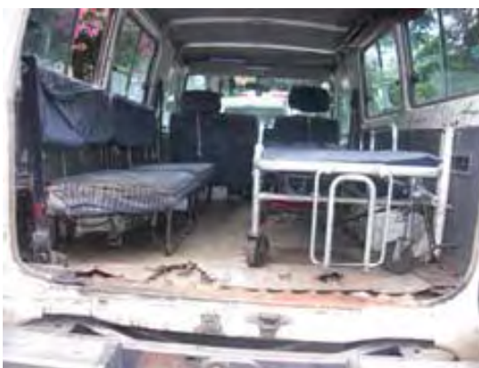
写真 5：イエベラプツェ病院の更新対象車両、床は痛みがひどく腐食が見える。
