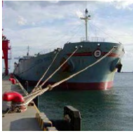
外航船（例）：積載量 65,500t 本船長さ 225m 幅32m
