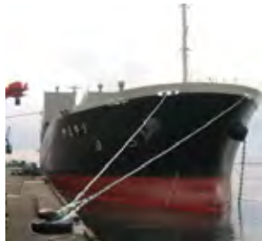
内航船「やまゆり」： 積載量 12,000t, 長さ 140m, 幅 26m, セルフアンローダ式
