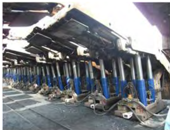
図 4-8 採炭切羽の天盤を支える自走枠
